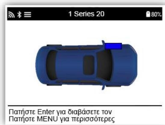
Εκτός από την πίεση και τη θερμοκρασία, εμφανίζουμε επίσης τη «λειτουργία» του αισθητήρα. Σε ορισμένες περιπτώσεις, ο τρόπος λειτουργίας δεν μπορεί να αλλάξει και δεν είναι σημαντικός, αλλά σε ορισμένες περιπτώσεις θα πρέπει να αλλάξει για να λειτουργήσει η εκμάθηση.
