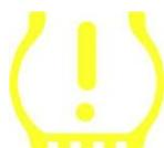
При выключении зажигания контрольный сигнал TPMS должен загореться и погаснуть. Это указывает на отсутствие неисправности в системе.
