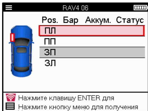
Помимо давления и температуры, мы также отображаем «режим» работы датчика. В некоторых случаях режим нельзя изменить и это не важно, но в некоторых случаях его нужно будет изменить, чтобы переобучение работало.
