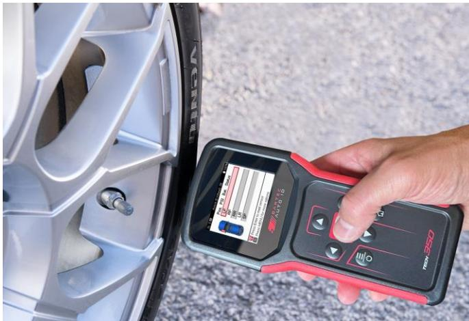
O tempo necessário para ler um sensor varia de acordo com a marca do sensor. A ferramenta exibirá uma barra de progresso que mostra o tempo máximo possível que o sensor pode levar.
