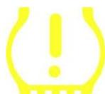
Ao pedalar a ignição para desligar, o avisador TPMS deve ligar e apagar. Isso indicaria um sistema sem falhas.
