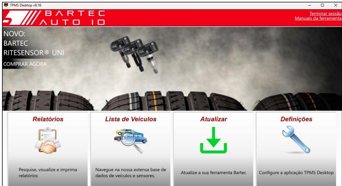
Ligue o TECH350 ao computador utilizando o cabo USB fornecido. O TPMS Desktop registrará automaticamente a ferramenta e exibirá a mensagem: "ferramenta registrada com sucesso".
