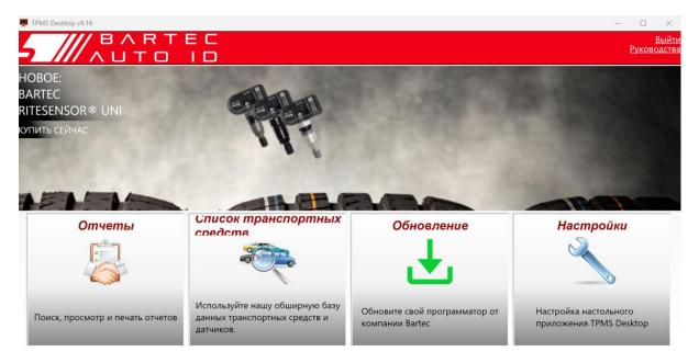
Подключите TECH600 к компьютеру с помощью прилагаемого USB-кабеля. TPMS Desktop автоматически зарегистрирует инструмент и отобразит сообщение: «Инструмент успешно зарегистрирован».
