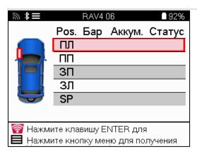
Помимо давления и температуры, мы также отображаем «режим» работы датчика. В некоторых случаях режим нельзя изменить и это не важно, но в некоторых случаях его нужно будет изменить, чтобы переобучение работало.
