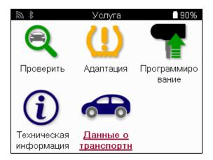
Данные о транспортном средстве обеспечивают прямой доступ к экранам, на которых отображаются данные о транспортном средстве. Это делает удобным проверку всех данных датчиков и OBD. Он также содержит данные о клиентах и дает возможность отправки данных.
