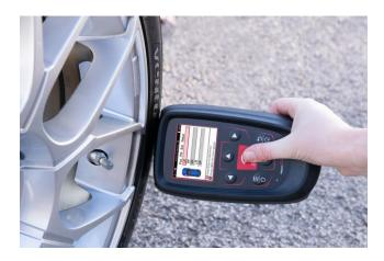
Время, необходимое для считывания показаний датчика, зависит от его марки. Инструмент отобразит индикатор выполнения, показывающий максимальное время, которое может потребоваться для считывания показаний датчика.
