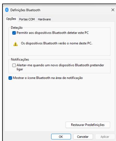
Inicie o aplicativo TPMS Desktop e vá para Configurações. Abra a secção Bluetooth e tome nota do nome do PC/portátil. Usando o Tech600, verifique o nome do PC / laptop mostrado e selecione-o para conexão, seguindo as instruções na tela da ferramenta.
