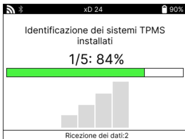
Al termine della ricerca, lo strumento indicherà che è riuscito a identificare il sistema. Dopo aver chiuso la finestra di dialogo, verrà visualizzata la schermata di servizio e lo strumento si configurerà per il tipo di sensore aftermarket identificato, inclusi Controllo, Riapprendimento, Programma e Informazioni.
