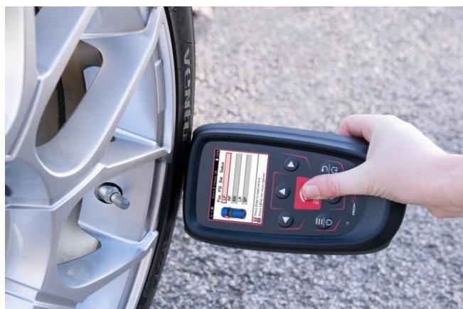
Il tempo necessario per leggere un sensore varia a seconda della marca del sensore. Lo strumento visualizzerà una barra di avanzamento che rappresenta il tempo massimo possibile impiegato dal sensore.
