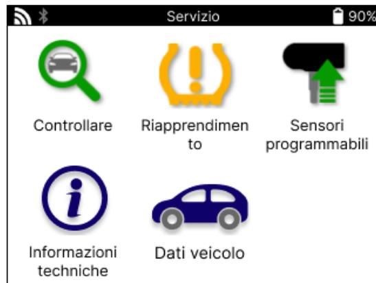
I Dati del Veicolo danno accesso diretto alle schermate che visualizzano i Dati del Veicolo. In questo modo è comodo controllare tutti i dati del sensore e dell'OBD. Contiene anche i dati dei clienti e offre la possibilità di inviare dati.
