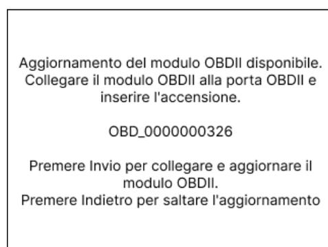
Collegare il modulo OBDII a un veicolo e impostare l'accensione su "On". Non avviare il motore. Premere "Invio" per collegare lo strumento al modulo BT OBDII e procedere con l'aggiornamento e seguire le istruzioni sullo schermo.
