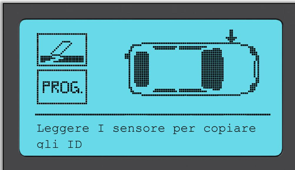
La copia del sensore richiede la lettura del vecchio sensore per programmare lo stesso ID sul sensore di ricambio per evitare il processo di riapprendimento.
