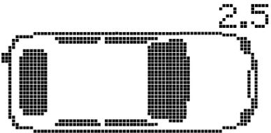
A diagram of a car wheel with two sensors. The right sensor is highlighted with a larger, darker area, and the number "2.5" is displayed above it. | <p><b>Letture sensore corretta</b></p> <p>Il sensore TPMS è stato attivato e decodificato correttamente. Visualizza la pressione (in Bar o PSI) nella posizione della ruota.</p>                                                                    |
