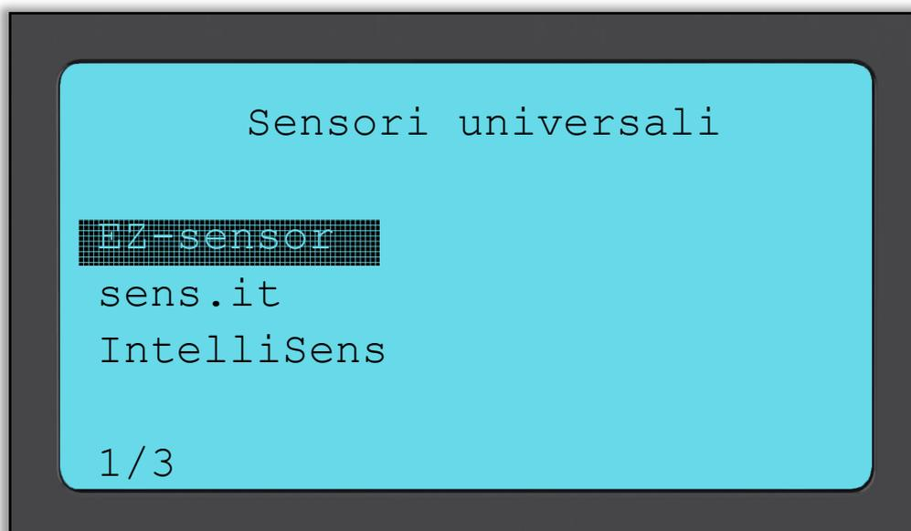
I sensori visualizzati possono variare, non tutti i sensori di ricambio sono compatibili con ogni veicolo.
