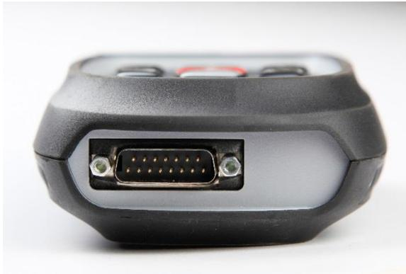
Il **collegamento OBDII** sul cavo viene utilizzato per collegarsi al veicolo per il riapprendimento
