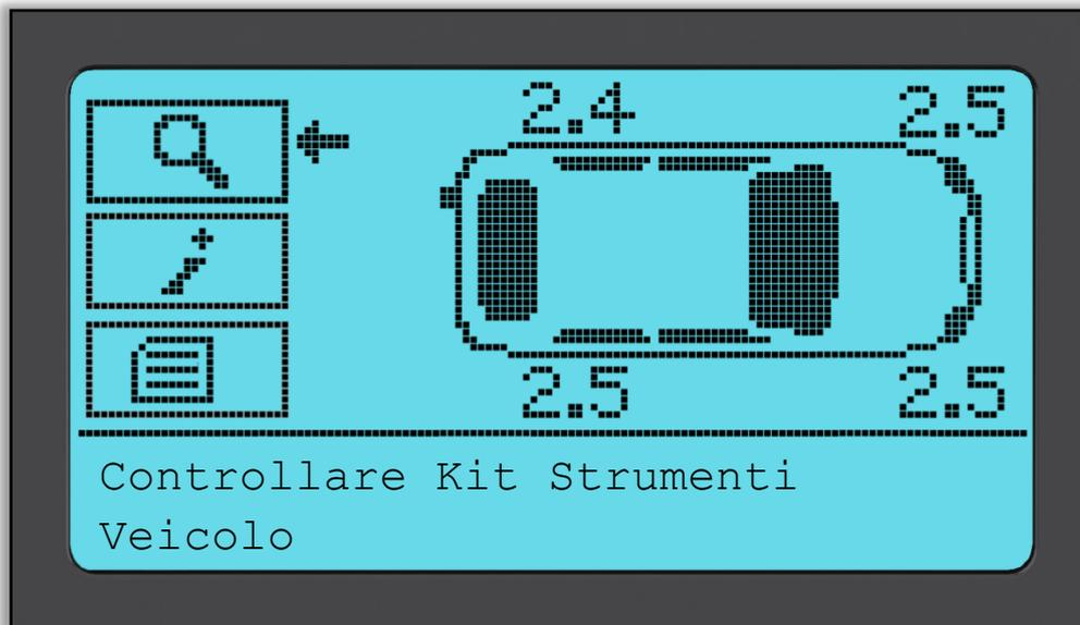
Se si ritorna allo schermo di Controllo veicolo, si possono utilizzare i tasti freccia per spostare la freccia sul Kit Strumenti Controllo Veicolo e premere il pulsante Invio.
