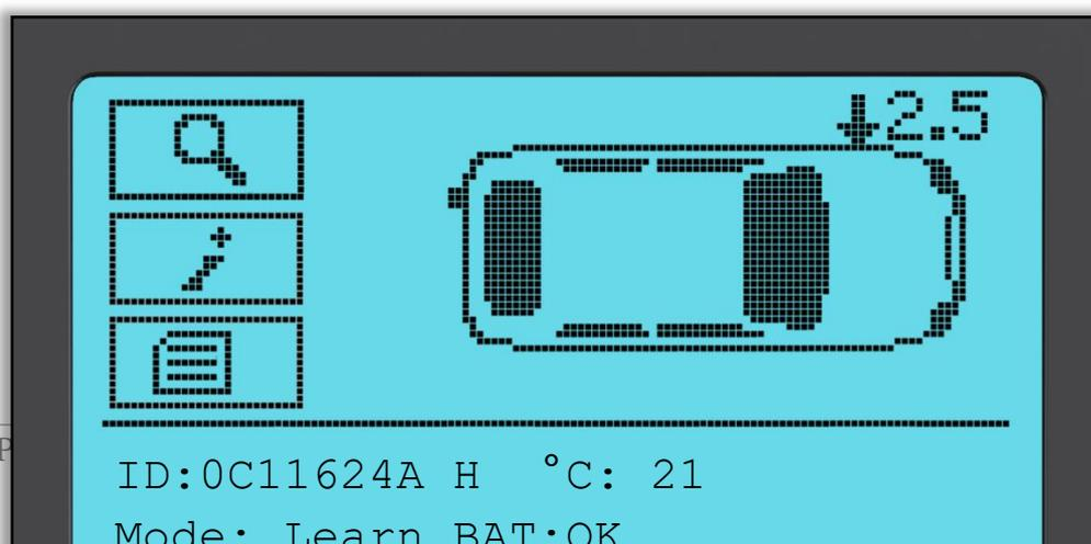
La freccia si sposterà automaticamente sulla posizione ruota successiva (Anteriore DX, Posteriore DX e quindi Posteriore SX), e la pressione sarà visualizzata rispetto alla posizione della ruota precedente, in Bar o PSI come selezionata in Impostazioni.
