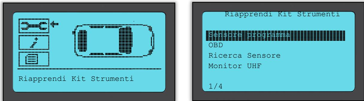
In questo caso il sensore anteriore sinistro è già stato letto, ma è necessario sostituirlo. Dopo la lettura, utilizzare il testo freccia giù per navigare al 'Riapprendi Kit Strumenti' quindi 'Programm. Sensore' e selezionare il sensore programmabile che si desidera utilizzare.
