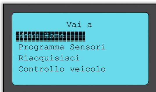
Utilizzando queste scelte rapide è possibile accedere velocemente alle funzioni mentre si mantengono i dati del sensore che possono essere utilizzati, ad esempio, per copiare i sensori.
