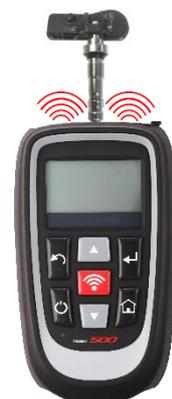
L'attrezzo ora mostrerà la posizione della ruota come 'programmata'. Tornare allo schermo controllo veicolo ed eseguire la scansione delle altre ruote.
