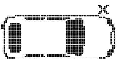
A diagram of a car wheel with two sensors. The right sensor is highlighted with a larger, darker area, and an "X" mark is placed above it.         | <p><b>Letture sensore incorretta</b></p> <p>Nessuna attivazione sensore o decodifica. Possibile incorretta installazione del sensore o sensore non funzionante. L'attrezzo richiederà all'utente di tentare la lettura del sensore per 3 volte.</p> |
