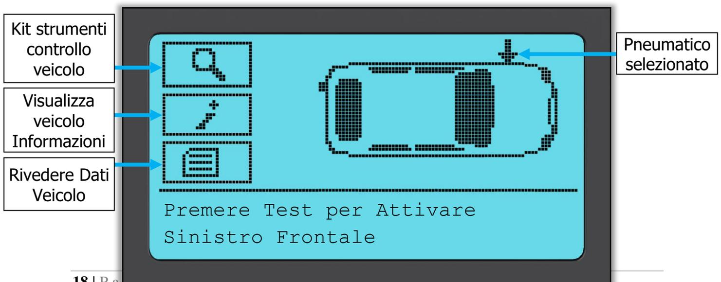
Durante il test, lo schermo conferma il tipo di sensore su cui si deve eseguire il test e visualizza una barra di avanzamento. La larghezza dello schermo mostra il tempo massimo possibile per una lettura corretta - marche diverse di TPM rispondono ad intervalli di velocità/tempo diversi.
