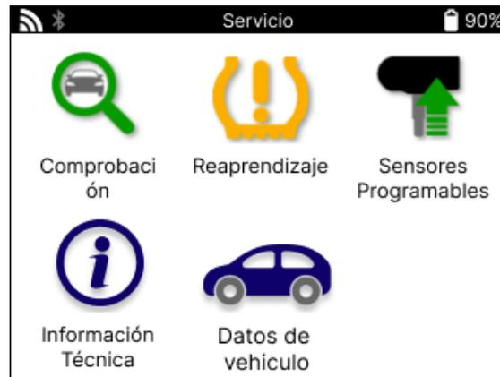
Datos del vehículo da acceso directo a las pantallas que muestran los Datos del vehículo. Esto hace que sea conveniente para comprobar todos los sensores, OBD, ruedas y neumáticos y volver a aprender los datos. También contiene datos del cliente y da la opción de enviar datos.
