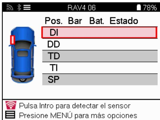
Además de la presión y la temperatura, también mostramos el «modo» del sensor. En algunos casos, el modo no se puede cambiar y no es importante, pero en otros, será necesario cambiarlo para que el reaprendizaje funcione.
