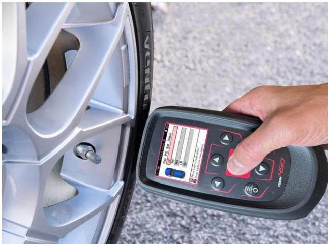
El tiempo que se tarda en leer un sensor varía en función de la marca del sensor. La herramienta mostrará una barra de progreso que indica el tiempo máximo que puede tardar el sensor.
