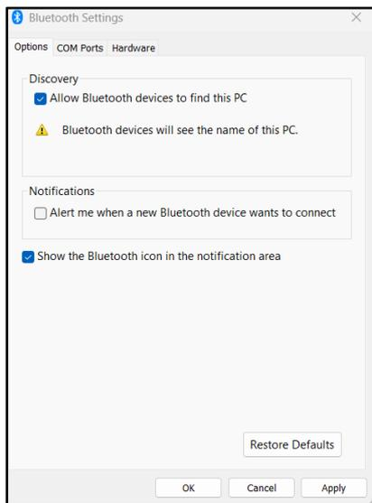
Inicie la aplicación TPMS Desktop y vaya a Configuración. Abra la sección Bluetooth y anote el nombre del PC/Ordenador portátil. Utilizando el Tech450, busca el nombre del PC/portátil mostrado y selecciónalo para la conexión, siguiendo las indicaciones en pantalla de la herramienta.
