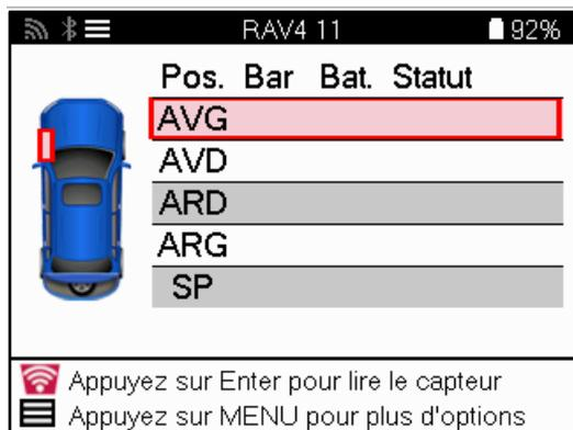
Outre la pression et la température, nous affichons également le « mode » du capteur. Dans certains cas, le mode ne peut pas être modifié et n'est pas important, mais dans d'autres cas, il doit être modifié pour que le réapprentissage fonctionne.
