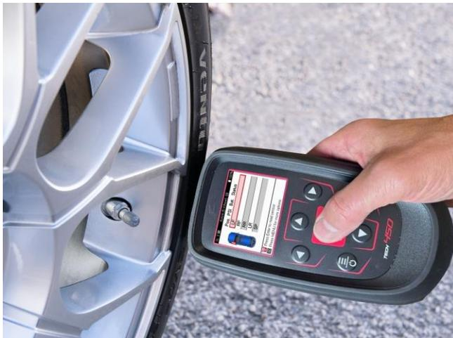
Le temps nécessaire à la lecture d'un capteur varie en fonction de la marque du capteur. L'outil affiche une barre de progression indiquant le temps maximum que peut prendre le capteur.
