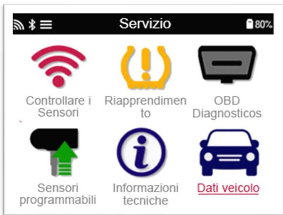
Il menu dà accesso diretto a schermate specifiche che visualizzano i dati del veicolo. Questa opzione è utile se l'utente desidera dare una seconda occhiata ai dati del sensore, ai dati OBD o desidera stampare i dati dall'ultimo veicolo elaborato tramite la stampante Bluetooth.
