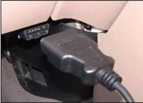
La **Connexion OBDII** du câble se branche au véhicule si elle est requise pour la programmation.
