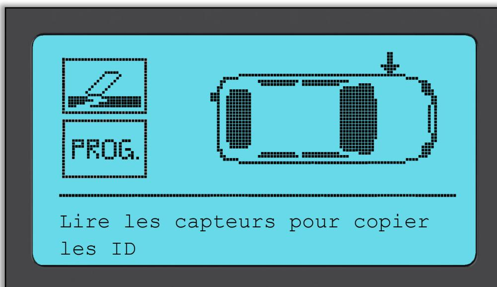
Copier un capteur requiert la lecture de l'ancien capteur pour programmer la même ID sur le capteur de rechange et éviter le processus de reprogrammation.
