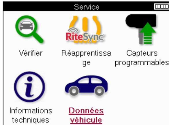
Les données du véhicule donnent un accès direct aux écrans qui affichent les données du véhicule. Il est ainsi possible de vérifier toutes les données des capteurs et de l'OBD.
