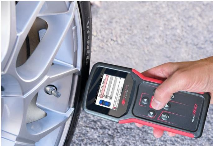
Le temps nécessaire à la lecture d'un capteur varie en fonction de la marque du capteur. L'outil affiche une barre de progression qui indique le temps maximum que peut prendre le capteur.
