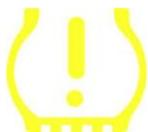
Al cambiar el encendido de apagado a en marcha, el testigo del TPMS debería encenderse y apagarse. Esto indicaría un sistema sin fallo presente.
