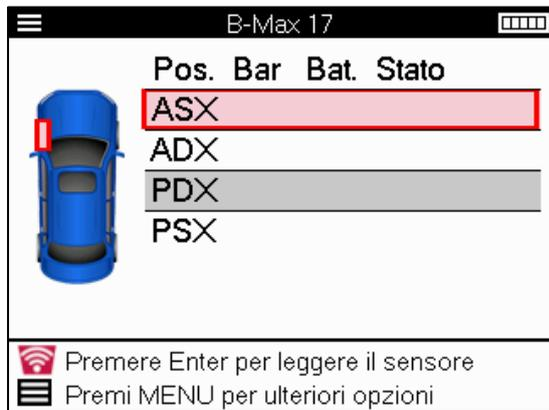
Oltre alla pressione e alla temperatura, viene visualizzata anche la “modalità” del sensore. In alcuni casi, la modalità non può essere modificata e non è importante, ma in altri casi è necessario cambiarla per far funzionare il riapprendimento.
