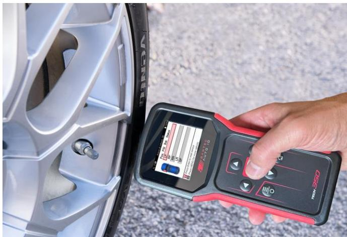
Il tempo necessario per leggere un sensore varia a seconda della marca del sensore. Lo strumento visualizza una barra di avanzamento che indica il tempo massimo che il sensore può impiegare.
