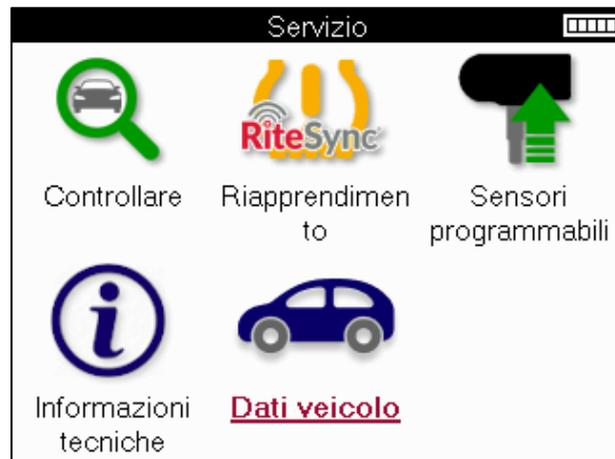
I dati del veicolo consentono di accedere direttamente alle schermate che visualizzano i dati del veicolo. In questo modo è possibile controllare comodamente tutti i dati dei sensori e dell'OBD.
