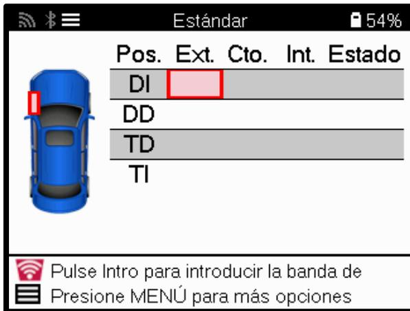
A medida que lea las profundidades de la banda de rodadura, la medición aparecerá en la pantalla de inspección de la banda de rodadura de la herramienta TPMS y almacenará los datos de la tienda de neumáticos y la información del cliente.
