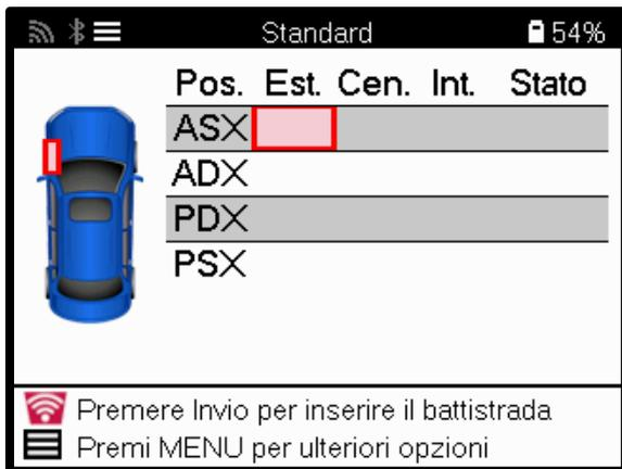
Durante la lettura delle profondità del battistrada, la misurazione apparirà sulla schermata di ispezione del battistrada dello strumento TPMS e memorizzerà i dati per il negozio di pneumatici e le informazioni sui clienti.
