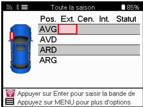
Lorsque vous lisez les profondeurs de la bande de roulement, la mesure apparaît sur l'écran d'inspection de la bande de roulement de l'outil TPMS et stocke les données pour le magasin de pneumatiques et les informations du client.
