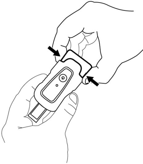
1. Retirer l'embout en appuyant fermement de chaque côté de l'embout.
