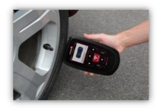
El tiempo que se tarda en leer un sensor varía en función de la marca del sensor. La herramienta mostrará una barra de progreso que indica el tiempo máximo que puede tardar el sensor.
