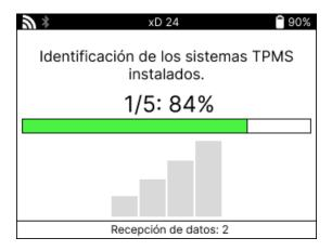
Cuando la búsqueda se haya completado, la herramienta indicará que ha tenido éxito en la identificación del sistema. Después de cerrar el cuadro de diálogo, se mostrará la pantalla de servicio y la herramienta se configurará ahora para el tipo de sensor posventa identificado, incluyendo Comprobación, Reaprendizaje, Programa e Información.
