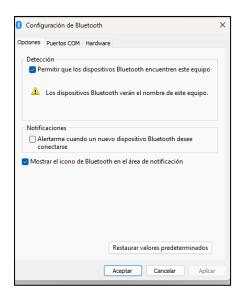
Inicie la aplicación TPMS Desktop y vaya a Ajustes. Abra la sección Bluetooth: el PC/portátil debe ser conectable y detectable para la TECH600.
