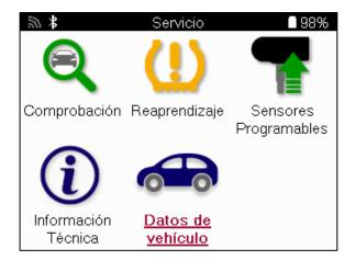
Los Datos del Vehículo dan acceso directo a las pantallas que muestran los Datos del Vehículo. Esto permite comprobar cómodamente todos los datos de los sensores y del OBD. También contiene datos del cliente y da la opción de enviar datos.
