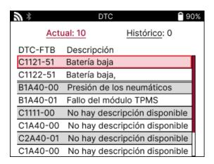
Los DTCs se agrupan en DTCs Actuales y DTCs Históricos, utilice las teclas izquierda y derecha para seleccionar entre los dos. Los DTCs se listan con el Código DTC y el Byte de Tipo de Fallo (FTB) junto con una descripción (si es compatible).
