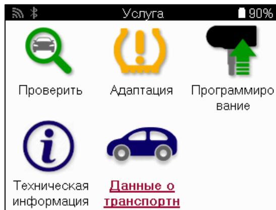
Данные о транспортном средстве обеспечивают прямой доступ к экранам, на которых отображаются данные о транспортном средстве. Это делает удобным проверку всех данных датчиков и OBD. Он также содержит данные о клиентах и дает возможность отправки данных.
