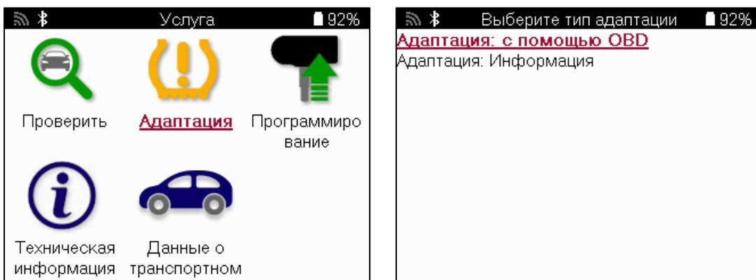
Чтобы узнать, какой тип перепрограммирования доступен для автомобиля, просто включите инструмент и выберите Relearn. Также можно обратиться к текущему списку поддерживаемых автомобилей на сайте [www.bartecautoid.com](http://www.bartecautoid.com) > Downloads.
