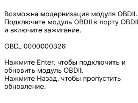
Подключите модуль OBDII к автомобилю установите зажигание в положение «Вкл.». Не запускайте двигатель. Нажмите 'Enter', чтобы подключить инструмент к модулю BT OBDII и продолжить обновление, следя подсказкам на экране.
