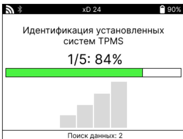
Когда поиск будет завершен, инструмент сообщит, что идентификация системы прошла успешно. После закрытия диалогового окна отобразится экран обслуживания, и инструмент настроит себя для идентифицированного типа датчика вторичного рынка, включая «Проверка», «Повторное обучение», «Программирование» и «Информация».
