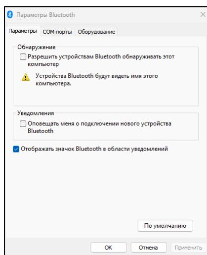
Запустите приложение TPMS Desktop и перейдите в раздел «Настройки». Откройте раздел Bluetooth и запишите имя ПК/ноутбука. С помощью Tech600 найдите отображаемое имя ПК/ноутбука и выберите его для подключения, следуя подсказкам на экране инструмента.
