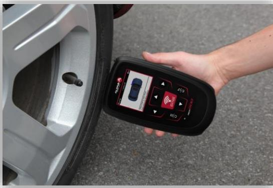
Время, необходимое для считывания показаний датчика, зависит от его марки. Инструмент отобразит индикатор выполнения, показывающий максимальное время, которое может потребоваться для считывания показаний датчика.
