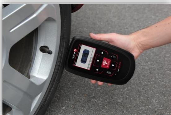
O tempo que demora a ler um sensor varia consoante a marca do sensor. A ferramenta apresenta uma barra de progresso que indica o tempo máximo possível que o sensor pode demorar.
