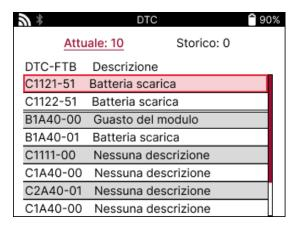
I DTC sono raggruppati in DTC correnti e DTC storici, utilizzare i tasti sinistro e destro per selezionare tra i due. I DTC sono elencati con il codice DTC e il byte del tipo di errore (FTB) insieme a una descrizione (se supportata).
