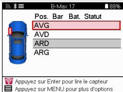
En plus de la pression et de la température, nous affichons également le « mode » du capteur. Dans certains cas, le mode ne peut pas être modifié et n'est pas important, mais dans d'autres cas, il devra être modifié pour que le réapprentissage fonctionne.
