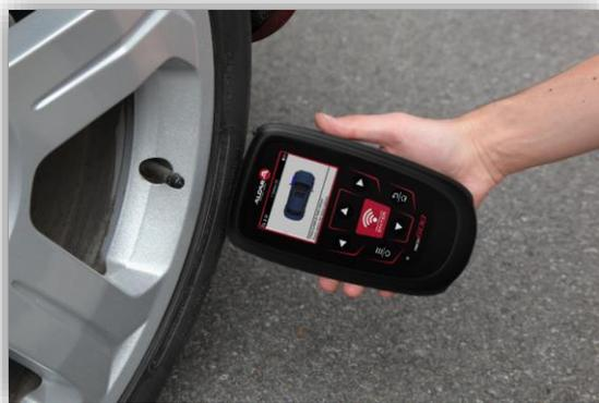
Le temps nécessaire à la lecture d'un capteur varie en fonction de la marque du capteur. L'outil affichera une barre de progression qui indique le temps maximum possible que le capteur peut prendre.
