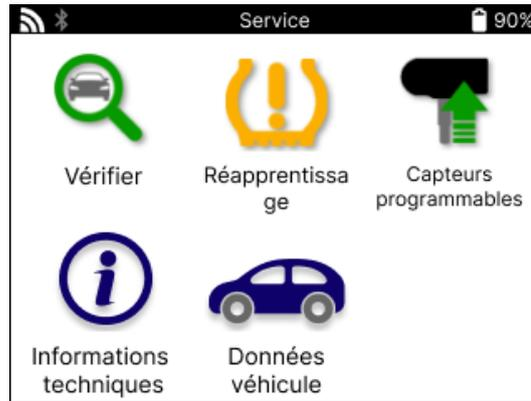
Les Données du Véhicule donnent un accès direct aux écrans qui affichent les Données du Véhicule. Il est donc facile de vérifier toutes les données du capteur et de l'OBD. Il contient également des données sur les clients et donne la possibilité d'envoyer des données.
