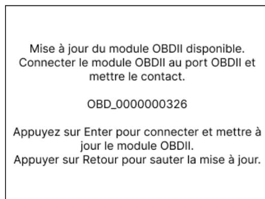
Connectez le module OBDII à un véhicule et réglez le contact sur « On ». Ne démarrez pas le moteur. Appuyez sur « Entrée » pour connecter l'outil au module BT OBDII et procédez à la mise à jour en suivant les instructions à l'écran.
