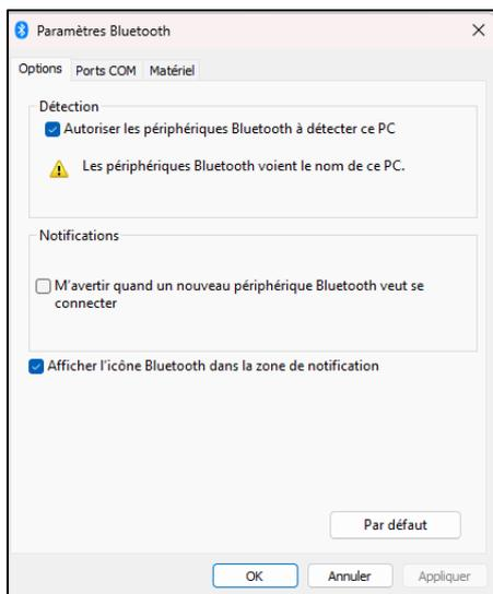
Démarrez l'application de bureau TPMS et accédez aux paramètres. Ouvrez la section Bluetooth: le PC/ordinateur portable doit être connectable et détectable pour le TECH600.
