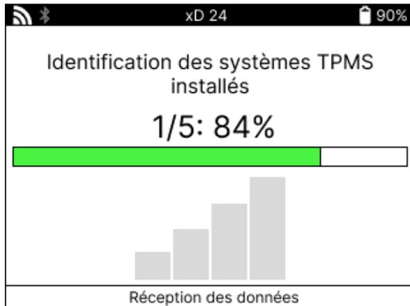
Une fois la recherche terminée, l'outil indiquera qu'il a réussi à identifier le système. Après la fermeture de la boîte de dialogue, l'écran de service s'affiche et l'outil se configure pour le type de capteur de rechange identifié, y compris Vérifier, Réapprendre, Programme et Informations.
